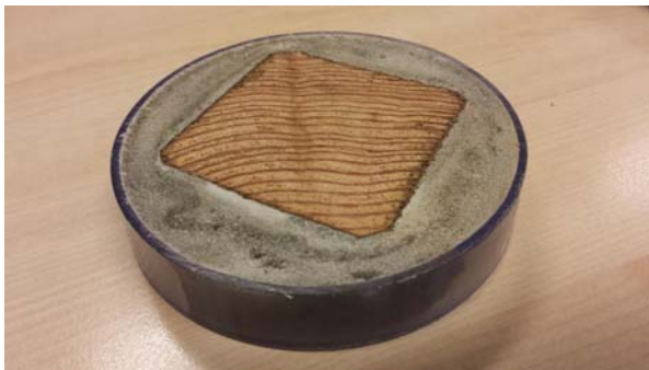
*Doorsnede Small Kit met houten paal 70x70mm, diameter paalgat 100mm, 70 cm diep
