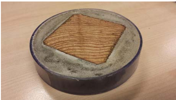
* Querschnitt Small Kit mit Holzpfahl 70x70mm – 70 cm tief
